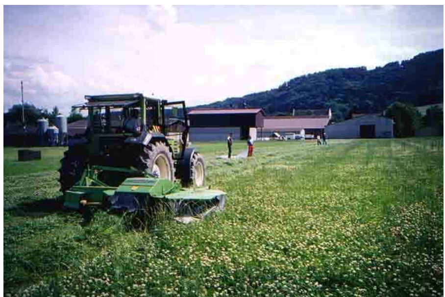
Fig. 3. Tracteur avec faucheuse latérale lors du fauchage du trèfle blanc.
